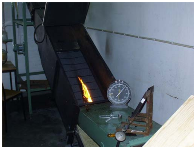
Brandprøvning efter NT Fire 006.
